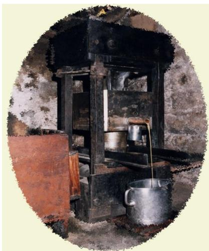
La presse hydraulique (photo ci-contre) de l'huilerie développe une puissance de 130 tonnes grâce à son vérin. Elle est supportée par 4 colonnes carrées forgées.
